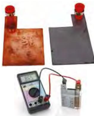
1 plaque de cuivre et 1 plaque de zinc 50 x 95 mm avec connecteur pour fiche banane  $\varnothing 4$  mm pour réaliser une pile avec la Smart'Cuv®.
