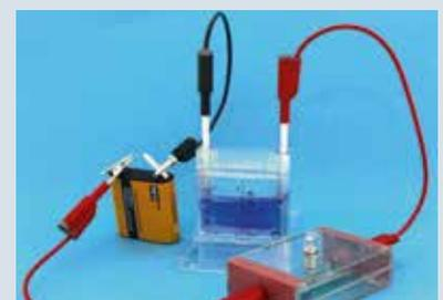
Mesure de conduction dans les liquides
