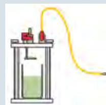
Un bécher de 100 mL forme haute contenant de l'eau à laquelle on a ajouté quelques gouttes de bleu de bromothymol est placé dans l'enceinte à réaction étanche.
