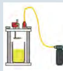
La couleur vire peu à peu au jaune à mesure que la pression augmente dans l'enceinte. La diminution de la valeur du pH prouve que la concentration de  $\text{CO}_2$  dissous augmente dans la
