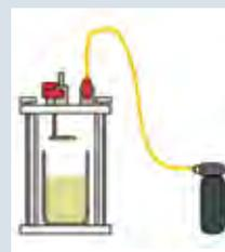
L'enceinte est mise progressivement sous pression de  $\text{CO}_2$  avec le régulateur pour cartouche de  $\text{CO}_2$ , relié au tube avec valve livré avec l'enceinte à réaction étanche.
