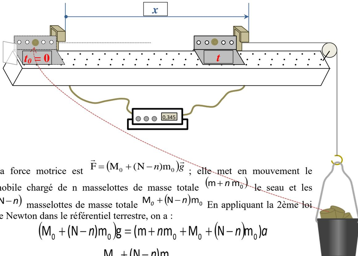
La force motrice est  $\vec{F} = (M_0 + (N-n)m_0)\vec{g}$  ; elle met en mouvement le mobile chargé de  $n$  masselottes de masse totale  $(m + nm_0)$  le seau et les  $(N-n)$  masselottes de masse totale  $M_0 + (N-n)m_0$ . En appliquant la 2ème loi de Newton dans le référentiel terrestre, on a :
