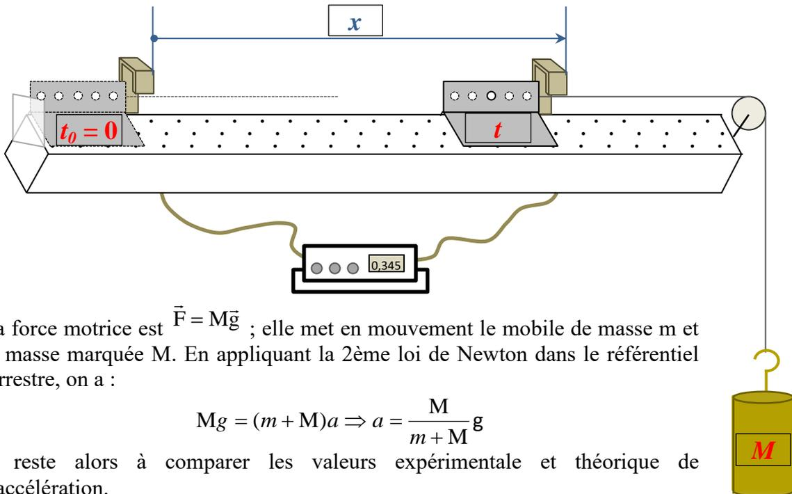
La force motrice est  $\vec{F} = M\vec{g}$  ; elle met en mouvement le mobile de masse  $m$  et la masse marquée  $M$ . En appliquant la 2ème loi de Newton dans le référentiel terrestre, on a :
