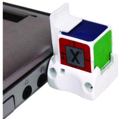
L'accéléromètre peut être utilisé à une distance de travail d'environ 10 m, en fonction de la pollution électromagnétique.
