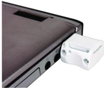
Lorsque la batterie est déchargée, le témoin lumineux de charge de la batterie, sur la face Z de l'accéléromètre, passe du vert au rouge. L'accéléromètre s'éteindra rapidement. Il convient de connecter l'accéléromètre sur l'adaptateur Bluetooth et de le brancher sur le port USB de votre ordinateur. Le témoin lumineux passe à l'orange. Le temps de charge est d'environ ½ heure pour 3 heures d'utilisation.
