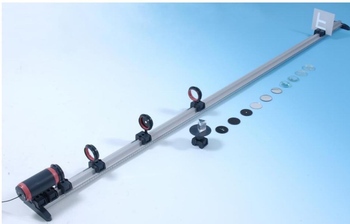
Les lentilles ou les objets  $\varnothing 50$  mm sont maintenus dans le porte-lentille à l'aide d'une bague vissée pour assurer un positionnement précis et éviter tout risque d'échappement et donc de casse.
