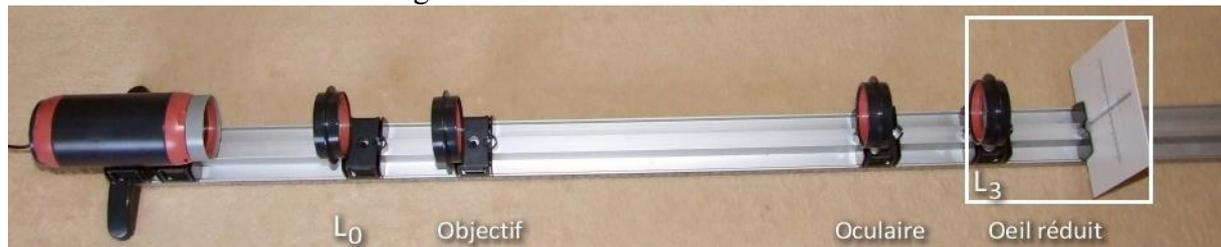
On positionne ensuite l'œil réduit à la place de l'objectif. L'image  $A_0' B_0' 3$  se forme sur l'écran et on mesure le même élément d'image.
