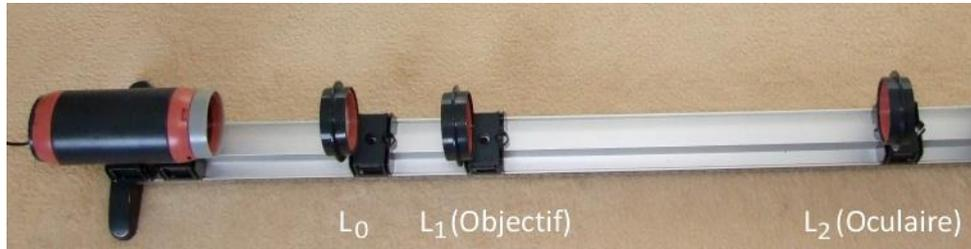
On place une lentille convergente  $L_1$  de grande distance focale connue (quelle que soit sa position sur le banc,  $L_1$  voit l'image de AB au travers de la lentille  $L_0$  à l'infini). Cette lentille  $L_1$  joue le rôle de l'objectif de la lunette astronomique.
