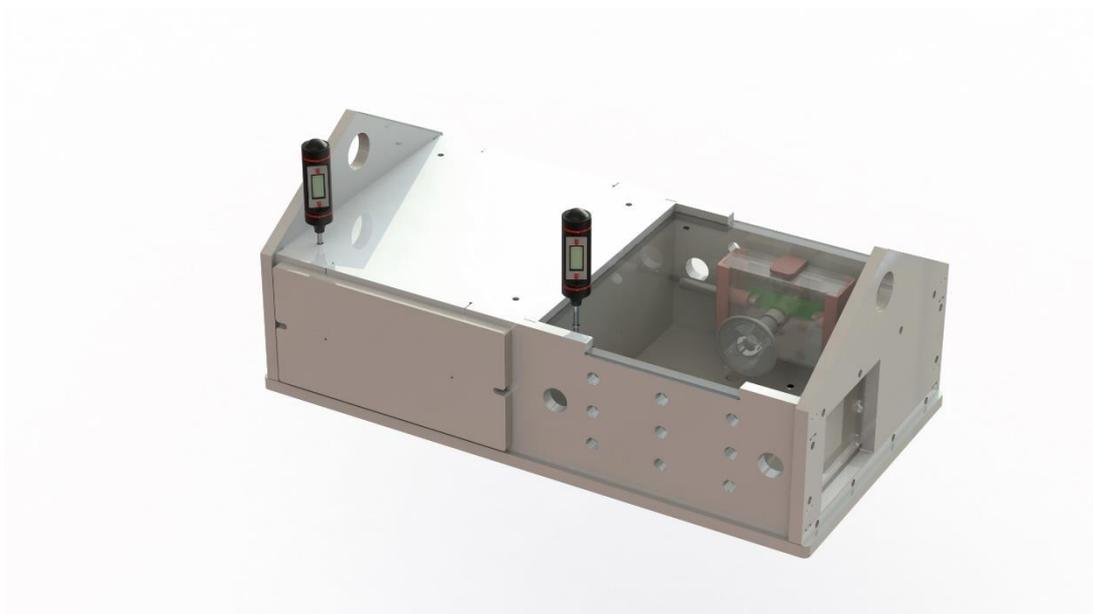
Placer et alimenter une lampe halogène en 6 V (ne pas utiliser le 12 V pour éviter les risques de brûlure) dans la pièce isolée et dans la pièce non isolée.
