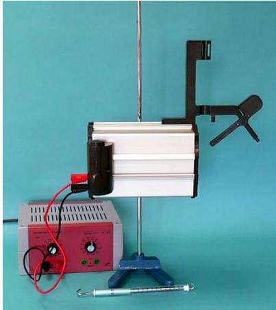
On positionne la potence sur la soufflerie et on connecte la soufflerie à un générateur de tension continue 12 V.
