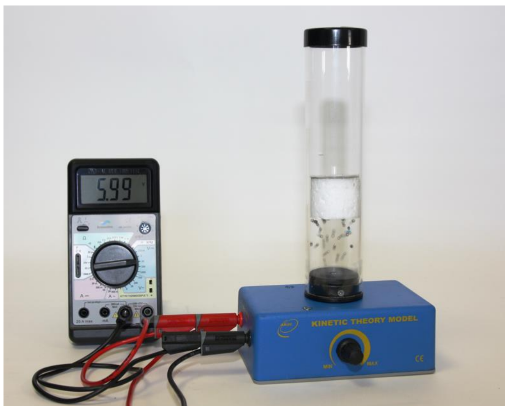
Exemple d'une expérience possible : la modélisation de la loi de Boyle-Mariotte
