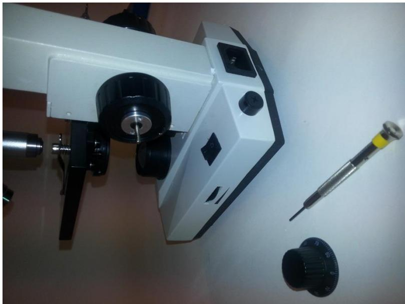
2. Déposer le bouton de la visse micrométrique :
