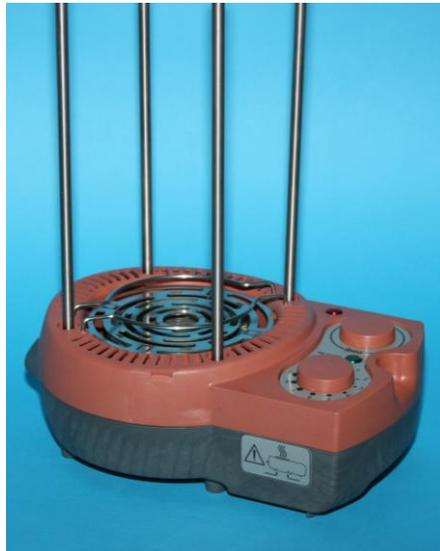
Le bec électrique permet de chauffer des liquides contenus dans différents récipients de diamètre allant jusqu'à 100mm (ballon, erlenmeyer, bécher).
