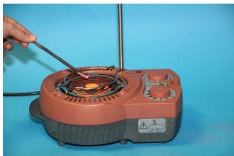
Il est aussi possible de créer une flamme sur la grille (zone de chauffe) du bec. Poser une pastille spéciale Ecoflam (réf 930 017) sur la zone de chauffe, celle-ci s'enflamme instantanément.
