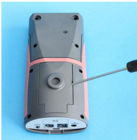
Pour ouvrir le casier à batterie, se munir d'un petit tournevis plat. Retourner l'appareil et introduire délicatement le bout du tournevis dans l'encoche située entre le couvercle du casier et le boîtier de l'appareil (schéma ci-dessus).
