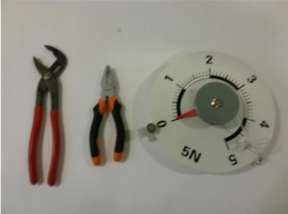
2. Dévisser l'aimant à l'arrière du dynamomètre :
