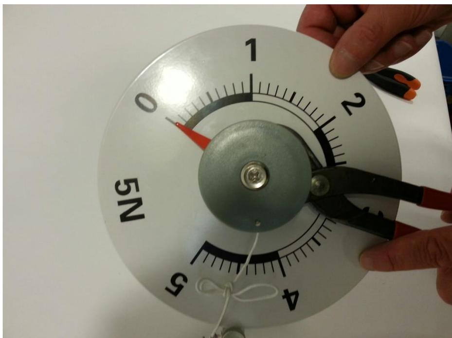
5. Serrer fermement l'écrou à l'arrière du dynamomètre :
