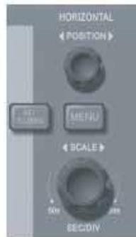
Figure 1-10 Zone de commandes horizontales sur le panneau avant
