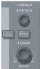
Figure 2-9 Interface système horizontal
