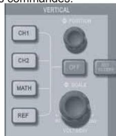
Figure 1-9 Zone de commandes verticales sur le panneau avant
