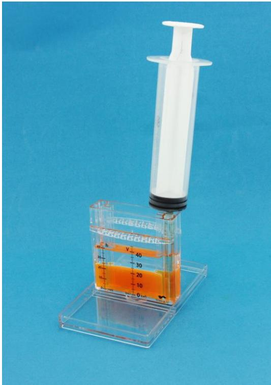
Mélanger dans la Smart'Cuv® 10 mL de White Spirit, 5 ml de sirop d'orange dilué dans 15 ml d'eau.
