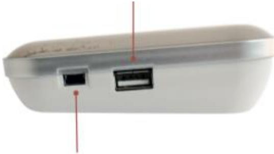
**Port de sortie audio** pour les signaux de tension CA et CC, pour la connexion à un amplificateur de puissance\*
