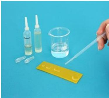
On observe que la goutte d'huile s'étale spontanément sur la languette tandis que la goutte d'eau ne s'étale pas du tout et minimise sa surface de contact avec la languette. Le comportement de ces deux liquides vis-à-vis d'une même surface hydrophobe est antagoniste.
