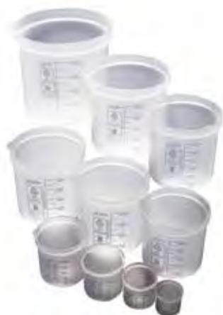
Autoclavables, résistance thermique jusqu'à 120 °C.
