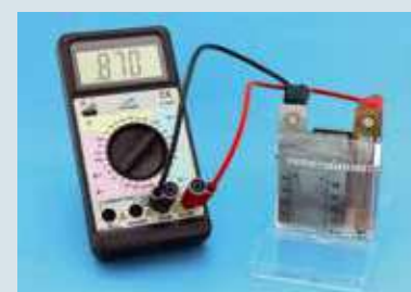
Réalisation d'une pile
