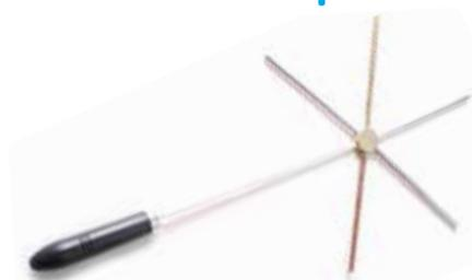
Étoile avec 5 branches métalliques : cuivre, laiton, fer, aluminium et nickel pour montrer la vitesse de propagation de la chaleur dans différents métaux.
