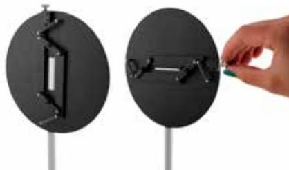
Une vis moletée permet d'ajuster en continu et en simultanément l'écartement de 0 à 9 mm. Un ressort de rappel est présent pour éviter les jeux.
