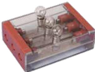
Chaque ampoule est indépendante et peut être montée en série ou en parallèle.
