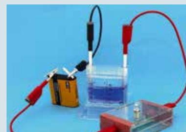
Mesure de conduction dans les liquides
