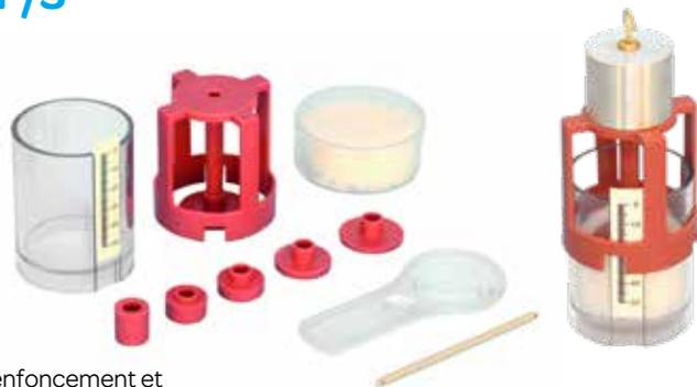
Mesurer précisément l'enfoncement et donc la pression exercée en fonction de la surface d'appui sur une matière floconneuse spéciale semblable à de la neige, très sensible à la pression. Les surfaces d'appui sont interchangeables et calibrées pour maintenir la masse du système pressant constante. L'échelle est graduée au 1/2 mm, avec le 0 ajustable exactement au niveau de la surface pour mesurer précisément l'enfoncement.
