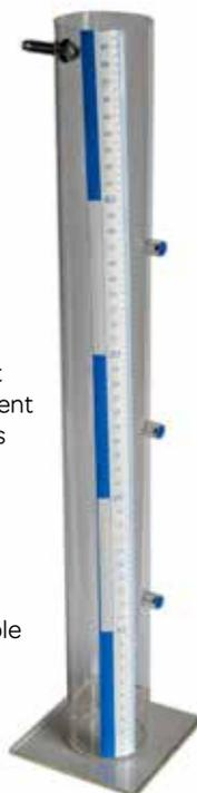
**TESTER LA LOI DE LA STATIQUE DES FLUIDES À L'AIDE D'UN MICROCONTRÔLEUR PROGRAMMÉ EN LANGAGE PYTHON**
