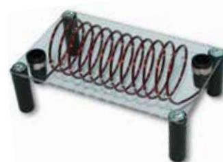
Utilisation avec du fer en poudre ou une aiguille aimantée. Base transparente pour visualisation sur rétroprojecteur.
