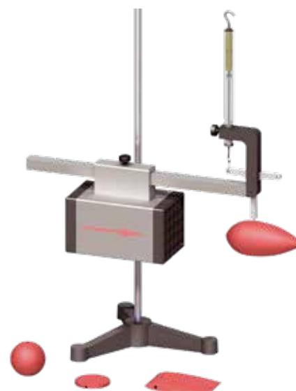
Dispositif d'étude des lois de l'aérodynamique. Compact, il se fixe sur un statif (non fourni) directement sur la paillasse de l'élève. Doté d'une soufflerie silencieuse, il peut être utilisé sur plusieurs postes élèves en même temps. Il permet d'étudier l'influence de la forme d'un solide sur sa résistance aérodynamique (trainée) et de vérifier que la résistance aérodynamique est proportionnelle au carré de la vitesse d'écoulement de l'air.
