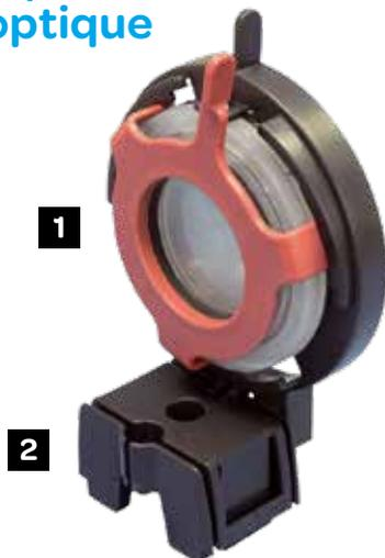
Lentille à focale variable pour l'étude de l'œil sur banc d'optique. Lentille souple remplie d'eau dont le rayon de courbure peut être modifié par pression périphérique en tournant la bague de réglage montée sur support hélicoïdal.
