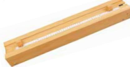
Une corde unique tendue sur une caisse de résonance en bois graduée sur 500 mm.
