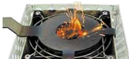
Plaque en acier épais à placer sur la grille du LAB 2 ou LAB 3 pour les expériences de combustion avec les pastilles écoflam (réf. 930 017).
