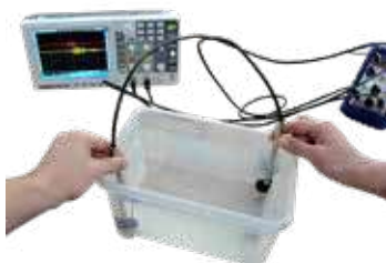
Mesure de la vitesse des US dans l'eau
