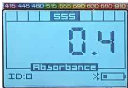
Mesure de l'absorbance ou de la transmittance à la longueur d'onde sélectionnée
