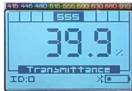
Mesure de l'absorbance ou de la transmittance à la longueur d'onde sélectionnée
