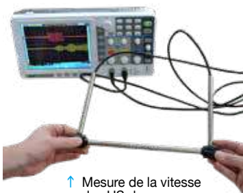
Mesure de la vitesse des US dans l'eau
