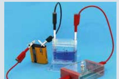
Mesure de conduction dans les liquides
