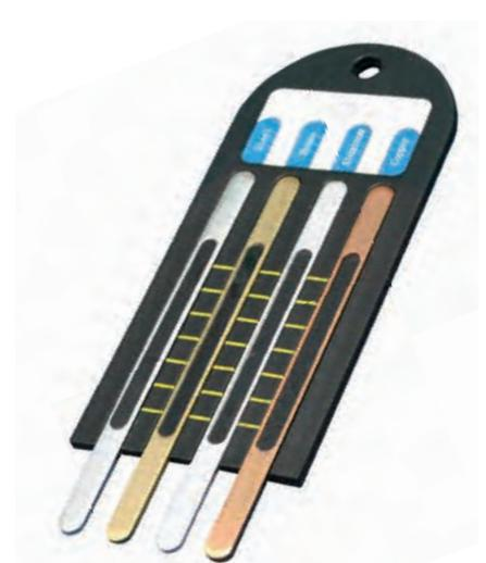
Appareil permettant de mettre en évidence les différentes conductibilités thermiques des métaux et alliages.
