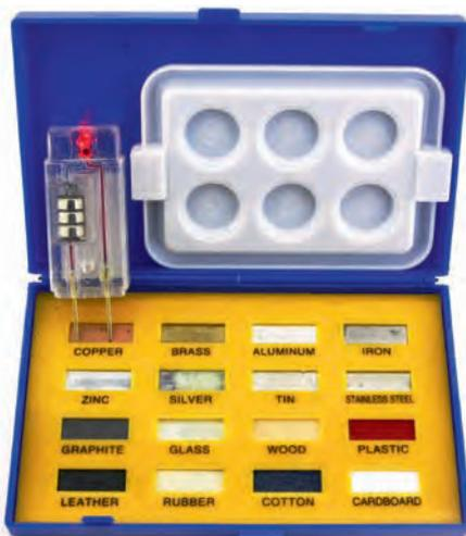
Malette contenant des échantillons de 16 matériaux (conducteurs et isolants) : cuivre, aluminium, fer, zinc, plomb, étain, acier inoxydable, laiton, graphite, verre, bois, plastique, cuir, caoutchouc, coton et carton.
