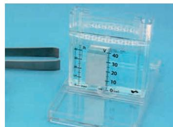
Cuve polyvalente transparente en plastique polycarbonate. Le format de la cuve, assez étroite, permet d'amplifier les variations de volume. Ce format permet des mesures précises de volumes immergés, notamment pour la détermination de la masse volumique. Le socle de la cuve très large assure la stabilité de la cuve, il sert également de bac de rétention en cas de débordement accidentel. A compléter par le jeu de 8 volumes Réf. 006 040 ci-dessous.
