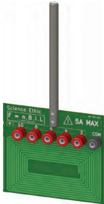
Le dispositif produit «  $F = n.B.I.L$  » se présente comme une bobine possédant 2, 4, 6, 8 ou 10 spires de pistes de cuivre. Il s'utilise avec un aimant en U, par exemple formé de deux « aimants ferrites » fixés sur un support en U.
