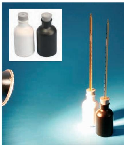
Fioles (1 blanche et 1 noire) livrées avec un bouchon percé pour le passage d'un thermomètre.
