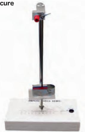
Une tige métallique en suspension est parcourue par un courant grâce à un fil très souple.
