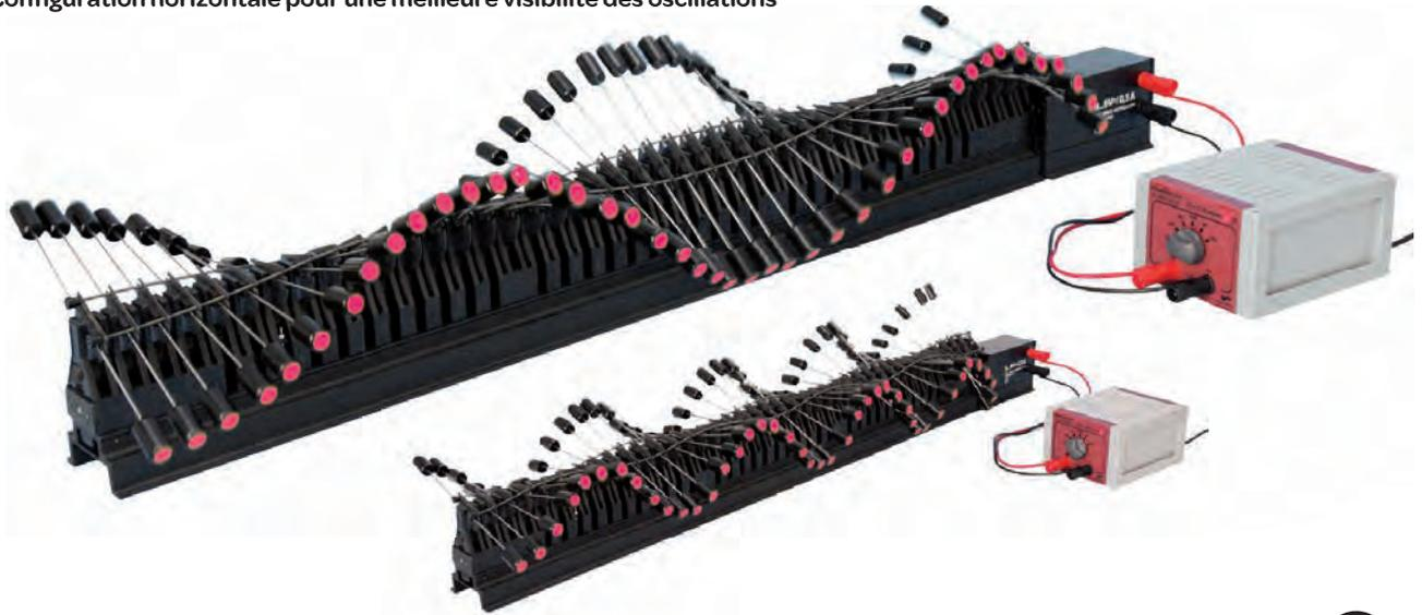
Constitué de 43 balanciers rapprochés et couplés par un dispositif élastique, il permet de visualiser aisément la propagation d'une perturbation (ébranlement provoqué manuellement, par exemple).
