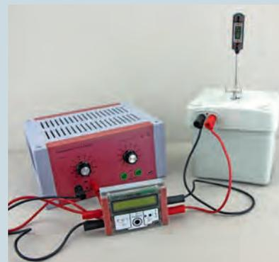
Mettre l'alimentation sous tension, et suivre la baisse de la température sur le thermomètre.
