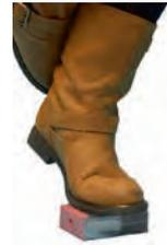
↑ Test de robustesse : supporte une charge de 100 kg
