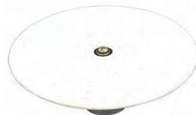
Disque en plastique de diamètre 20 cm équipé d'un roulement à billes et d'une base magnétique avec des trous à intervalle de 1 cm sur 12 axes à angles de 30°.
