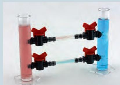
4) Observer le phénomène de convection dans les tubes latéraux et la répartition des masses d'eau dans les vases.
