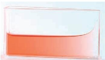
Cuve en plexiglas en forme de prisme, angle de  $10^\circ$ , pour montrer le phénomène de capillarité et la tension de surface des liquides.
