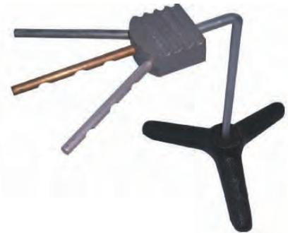
Maquette permettant de comparer la conduction thermique de 3 matériaux différents.
