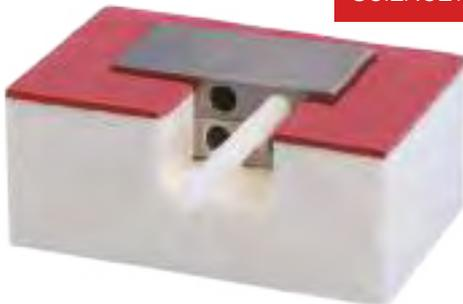
Maquette pour l'étude du transfert de l'énergie thermique par conduction entre deux blocs métalliques.
