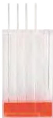
4 tubes capillaires 250 mm en verre de diamètres internes différents sont placés sur un support en plexiglas avec cuve intégrée et tube de remplissage.
