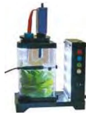
Pour l'étude de la photosynthèse et de la respiration. Composée d'une enceinte en plastique transparent équipée d'un couvercle avec 2 trous Ø 27 mm avec bouchons pour recevoir différentes sondes : oxymètre et/ou CO<sub>2</sub> mètre et thermomètre.
