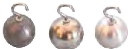
Jeu de 3 sphères de diamètre 20 mm avec anneau de suspension, pour faire varier le paramètre masse lors de l'étude de différents types de pendule.
