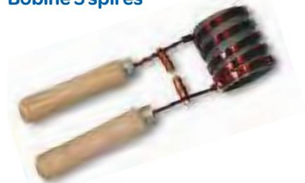
5 spires Ø 60 mm, 2 poignées en bois et 2 contacteurs en cuivre pour réaliser l'expérience de la soudure par point à l'aide du transformateur ci-dessus.
