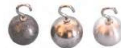
Jeu de 3 sphères de diamètre 19 mm de masses différentes avec anneau de suspension.
