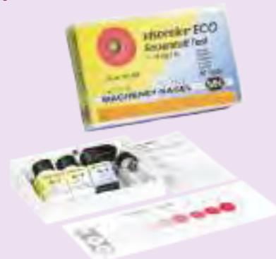
Kit de test colorimétrique pour la détermination semi-quantitative de la concentration en dioxygène dissous.
