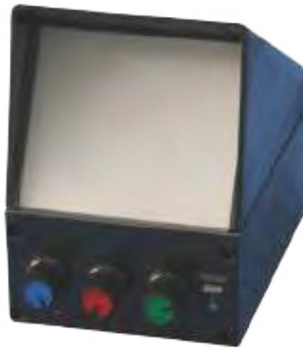
Trois boutons de réglage permettent de doser, indépendamment l'une de l'autre, l'intensité lumineuse des couleurs bleu, vert et rouge et de réaliser précisément la synthèse des couleurs.
