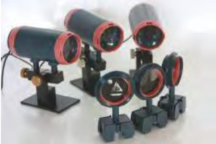
Ensemble très complet permettant d'étudier le mélange des couleurs avec 3 sources lumineuses LED (rouge, verte et bleue) à faisceaux quasiment parallèles.
