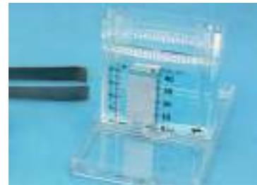
Cuve polyvalente transparente en plastique polycarbonate. Le format de la cuve, assez étroite, permet d'amplifier les variations de volume. Ce format permet des mesures précises de volumes immergés, notamment pour la détermination de la masse volumique. Le socle de la cuve très large assure la stabilité de la cuve, il sert également de bac de rétention en cas de débordement accidentel. A compléter par le jeu de 8 volumes Réf. 006 040 ci-dessous.
