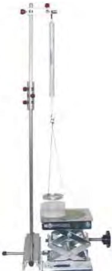
Un anneau en aluminium à bord biseauté est suspendu par 3 fils et 1 œilleton.
