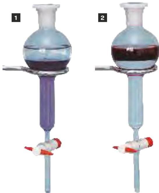
Ce kit permet aux élèves de réaliser une expérience spectaculaire et visuelle sur la solubilité d'un indicateur coloré. En effet la solubilité de l'indicateur dans un solvant dépend des interactions intermoléculaires qu'il crée avec le solvant.
