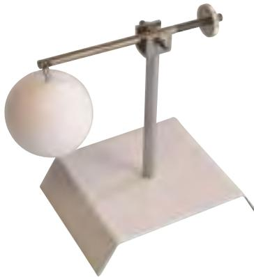
Principe : le baroscope à boule s'utilise avec une platine à vide. Une fois que le vide est établi, la pression atmosphérique ne s'exerce plus sur la boule en polystyrène et l'équilibre est rompu.
