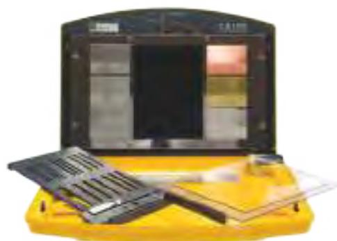
Ce banc didactique est composé d'une plaque chauffante 50°C équipée de plusieurs cibles d'états de surface et de matériaux différents, ainsi que d'écrans de test qui se fixent sur l'avant du banc à l'aide d'aimants.
