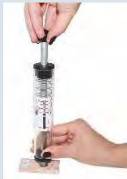
Le diamètre de l'impact sur la surface dépend de la dureté de l'échantillon : plus la matière sera dure, plus le diamètre sera petit.
