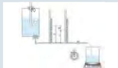
**Principe :** le vase de Mariotte assure un débit d'écoulement constant, tant que l'extrémité inférieure du tube (t) plonge dans l'eau. L'extrémité supérieure du tube est en contact avec l'air atmosphérique. Pour faire varier le débit, il suffit d'enfoncer plus ou moins le tube (t) dans le vase de Mariotte. Le système est conçu pour générer un écoulement laminaire.
