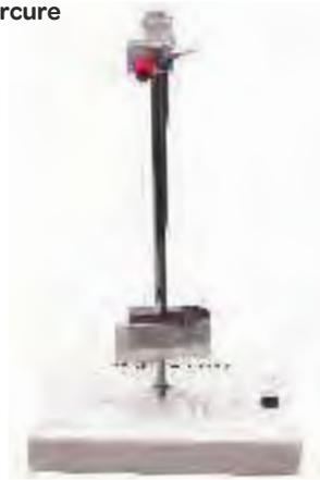
Une tige métallique en suspension est parcourue par un courant grâce à un fil très souple.
