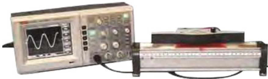
Pendule élastique horizontal sur coussin d'air permettant de réaliser l'étude des oscillations libres.
