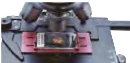
Support permettant d'utiliser des lames minces de roche (45 x 30 mm) avec un microscope à surplatine.
