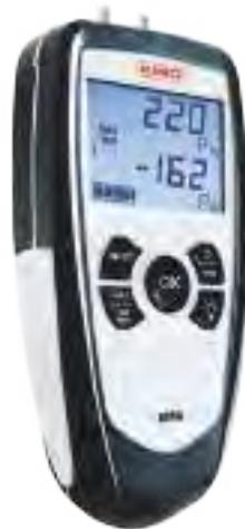
Utilisation pour le contrôle de pression dans les conduits de fumée, chambres de combustion, flux laminaire.
