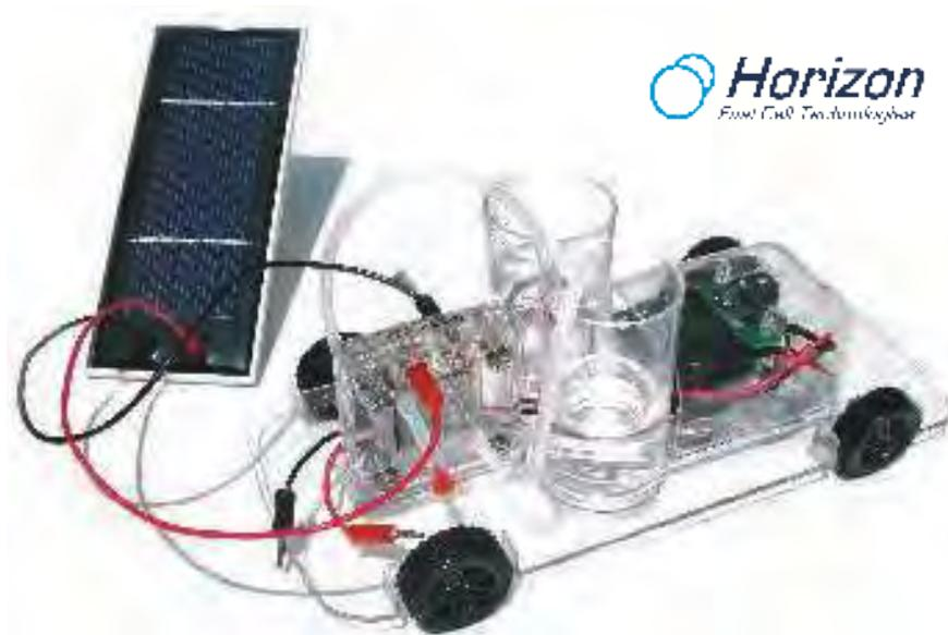
Cette maquette de voiture équipée d'une pile à combustible permet d'illustrer de manière ludique et spectaculaire la conversion de l'énergie électrique en énergie mécanique. L'énergie électrique provenant de la cellule photovoltaïque ou de l'alimentation (fournie) est transformée en énergie chimique par la pile à combustible réversible sous forme chimique ( $H_2$  et  $O_2$ ). Les gaz sont stockés dans les réservoirs gradués et transformés à
