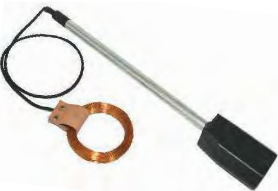
La bobine est reliée à un fil souple est alimentée par une prise bipolaire.
