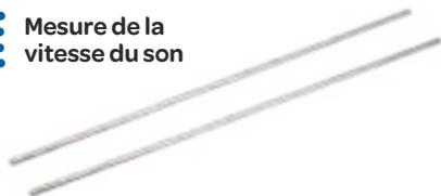
Deux baguettes métalliques creuses  $\varnothing$  interne 4 mm peuvent être reliées à l'entrée synchronisation d'un système d'acquisition de données (ExAO) grâce à 2 cordons banane  $\varnothing$  4 mm (non fournis). Elles permettent de générer un bruit sec et, simultanément, de court-circuiter l'entrée synchronisation de votre système d'acquisition.
