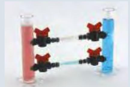
4) Observer le phénomène de convection dans les tubes latéraux et la répartition des masses d'eau dans les vases.
