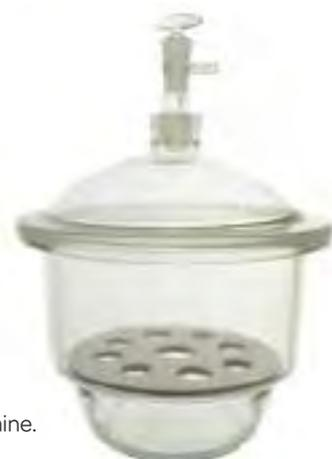
Robinet en verre pour tube de diamètre intérieur 8 mm.
