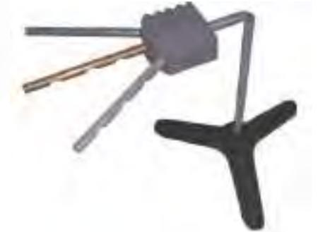
Maquette permettant de comparer la conduction thermique de 3 matériaux différents.
