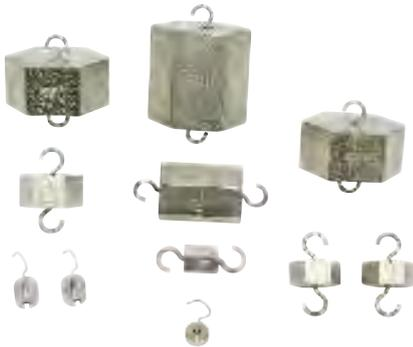
Série de masses à crochet hexagonales qui ne roulent pas, nickelées, totalisant 500 g.
