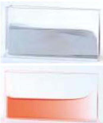
Cuve en plexiglas en forme de prisme, angle de  $10^\circ$ , pour montrer le phénomène de capillarité et la tension de surface des liquides.
