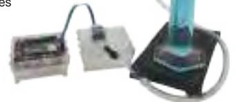
Etalonnage d'un capteur de température résistif ↓
