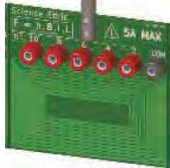
Le dispositif produit «  $F = n.B.I.L$  » se présente comme une bobine possédant 2, 4, 6, 8 ou 10 spires de pistes de cuivre. Il s'utilise avec un aimant en U, par exemple formé de deux « aimants ferrites » fixés sur un support en U.
