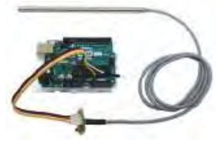
↑ Exemple de connexion du capteur de température CTN inclus dans le coffret 652 111, sur carte Arduino™ nue, à l'aide d'un câble Grove-Picots 658 073
