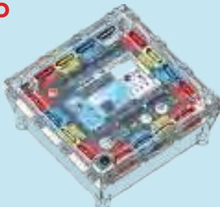
Elle est programmable en langage Arduino™. Elle est aussi programmable en Python grâce à notre librairie Plug'Python qui interprète Python pour Arduino™. Elle accepte les capteurs Plug'Uino®, Grove ou Arduino®.
