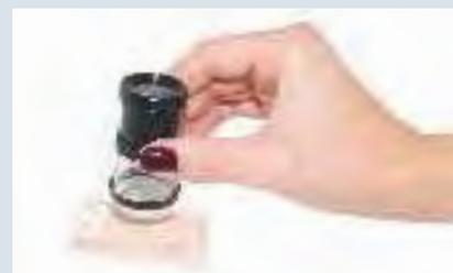
A l'aide d'un crayon graphite, griser le contour de l'impact pour faciliter la mesure du diamètre avec la loupe aplanétique.
