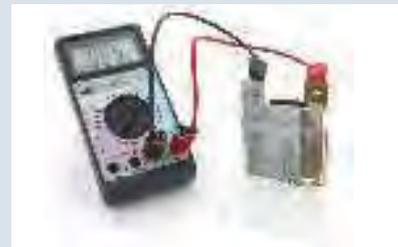
1) Remplir la Smart'Cuv® d'eau déminéralisée. Positionner 2 plaques de métaux différents dans les rainures de la Smart'Cuv®.
