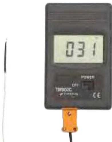
Thermomètre à sonde thermocouple type K. Compact et très simple d'emploi.
