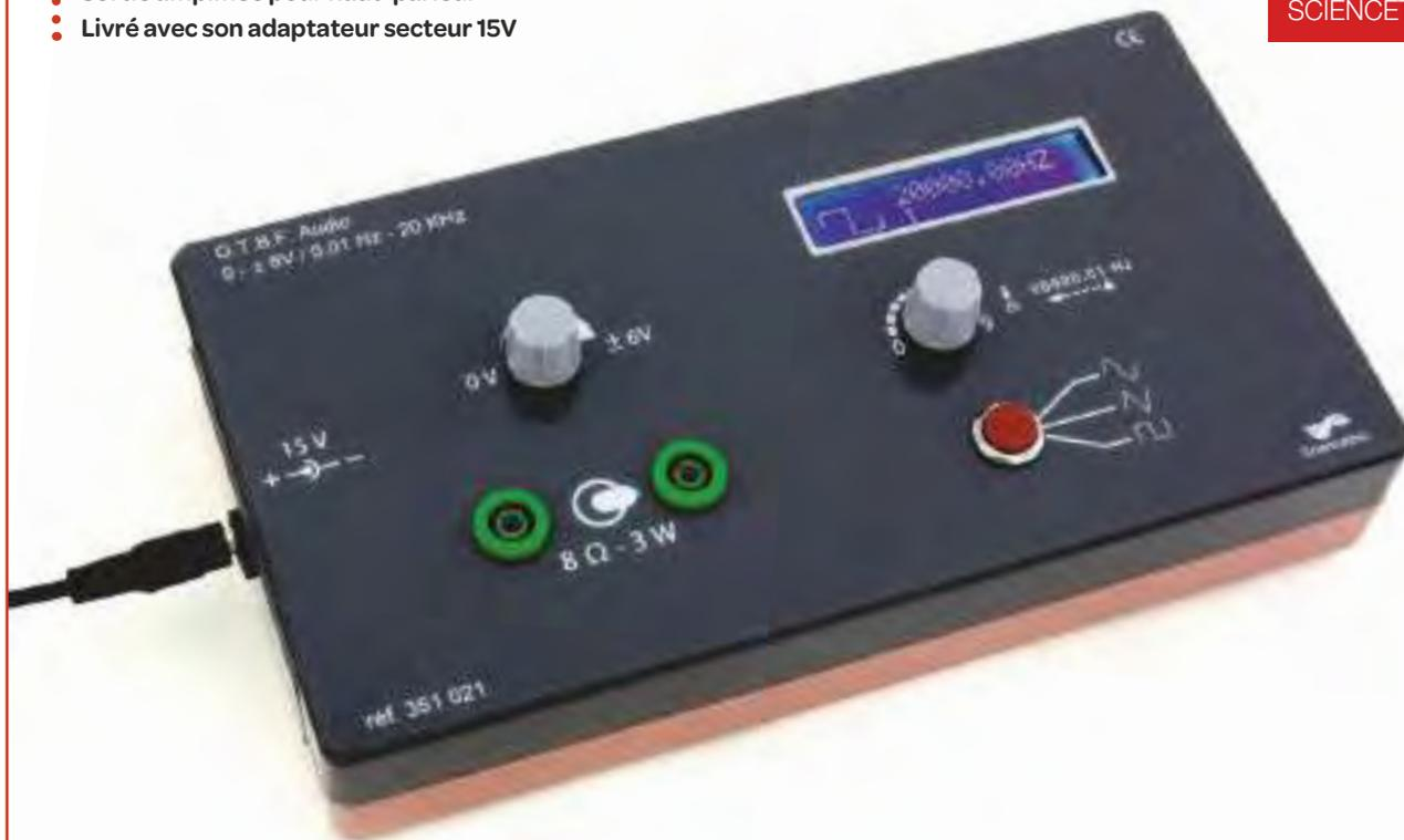
Affichage de la fréquence en Hz et de la forme du signal sur écran LCD.
