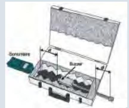
L'expérience consiste à positionner la source sonore (buzzer) à une distance  $d$  donnée du sonomètre et à noter le niveau sonore correspondant  $L$ . À l'aide d'un tableau on détermine  $1/d^2$  (en  $\text{m}^{-2}$ ) et
