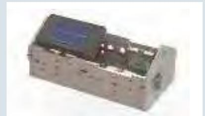
Comparer à l'aide du Joulemètre la puissance consommée par une ampoule LED E10 3,5 V (réf. 401 048) ou une ampoule à filament E10 3 V (réf. 401 002), toutes les 2 alimentées en 3 V. Comparer l'éclat de chaque lampe.
