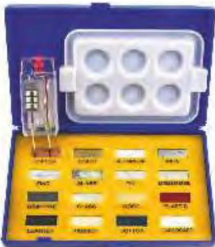
Mallette contenant des échantillons de 16 matériaux (conducteurs et isolants) : cuivre, aluminium, fer, zinc, plomb, étain, acier inoxydable, laiton, graphite, verre, bois, plastique, cuir, caoutchouc, coton et carton.
