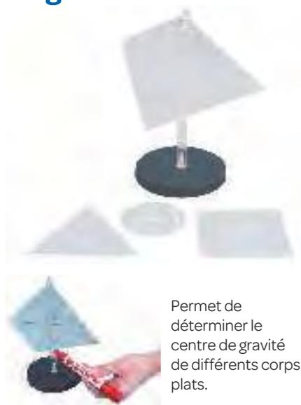
Permet de déterminer le centre de gravité de différents corps plats.
