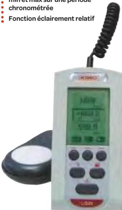
Permet des mesures d'éclairage en lux ou en candelas-pieds.
