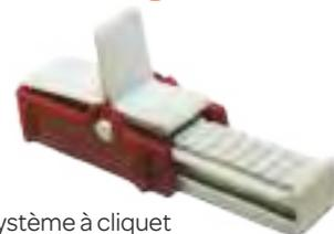
Système à cliquet et gâchette pour stocker et libérer de l'énergie d'un ressort en compression. Permet l'étude de l'énergie de mouvement. Fixation sur voiturette ou rails Plug'Uino®, avec support fourni.
