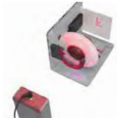
Lettre F composée de 12 LED alimentées par un adaptateur secteur (fourni), simulant un objet à l'infini.
