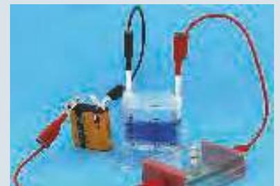
Mesure de conduction dans les liquides
