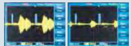
↑ Réflexion sur écran PVC placé à une distance  $d_1$     ↑ Réflexion sur écran PVC placé à une distance  $d_2$
