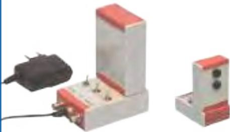
Boîtier disposant d'un émetteur et d'un récepteur ultrasons (40 kHz) côte-à-côte et alignés sur un même axe. L'émetteur peut émettre en mode continu ou en mode salves longues ou salves courtes. Les signaux émis et reçus sont accessibles sur 2 prises BNC.
