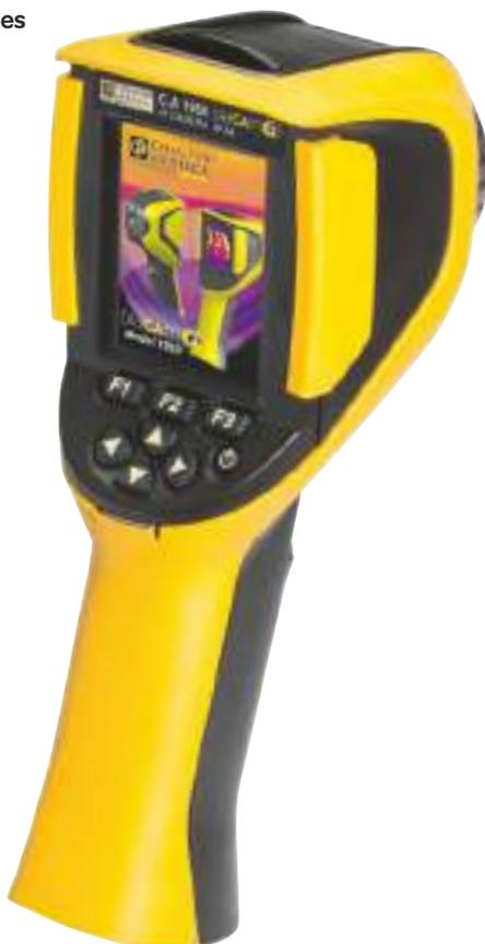
Mode de visualisation : image thermique, image réelle avec compensation automatique de parallaxe.
