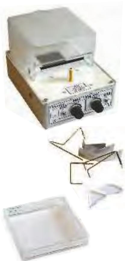
Elle permet d'observer les phénomènes de diffraction, réfraction et interférences. La cuve est positionnée sur une base qui produit les ondes et la lumière. Les ondes sont observables sur un écran blanc situé au-dessus de la cuve. La fréquence des ondes est réglable. La fréquence du stroboscope peut être synchronisée avec la fréquence d'excitation, ou réglable manuellement à l'aide d'un potentiomètre.
