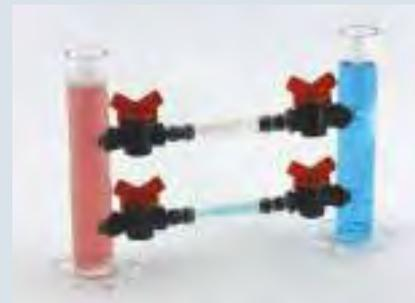
4) Observer le phénomène de convection dans les tubes latéraux et la répartition des masses d'eau dans les vases.
