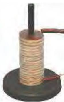
Pile composée d'un empilement de 10 éléments cuivre/zinc séparés par un disque de feutre.
