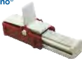
Système à cliquet et gâchette pour stocker et libérer de l'énergie d'un ressort en compression. Permet l'étude de l'énergie de mouvement. Fixation sur voiturette ou rails Plug'Uino® avec support fourni.
