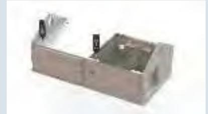
Placer et alimenter une lampe halogène alimentée en 6 V (pour éviter les risques de brûlure) dans la pièce isolée et dans la pièce non isolée. Positionner la sonde d'un thermomètre dans chaque pièce, loin de la source de chaleur.
