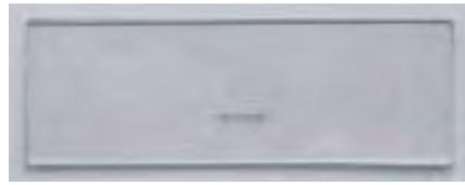
Lame de verre. Échelle graduée de 1 mm au 1/100<sup>e</sup> de mm. Pour étalonner l'objectif micrométrique.
