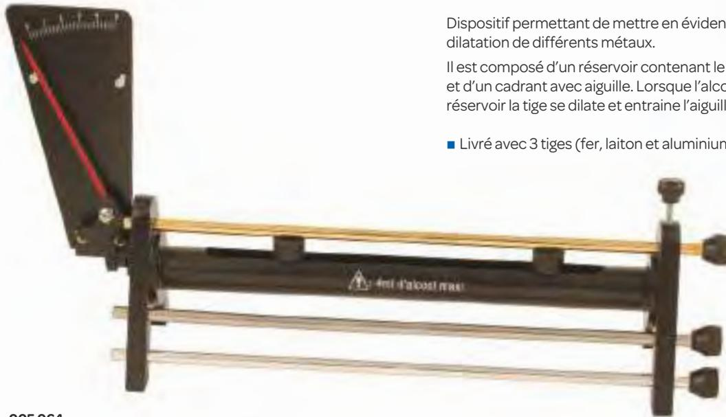
Dispositif permettant de mettre en évidence et de comparer la dilatation de différents métaux.
