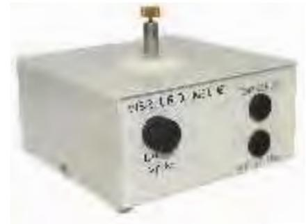
Dispositif très compact constitué d'un haut-parleur robuste, dont la membrane assure la transmission de la vibration à un axe positionné en son centre.
