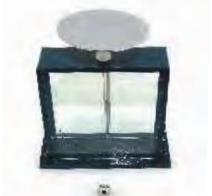
En présence de charges l'aiguille de l'électroscope pivote.
