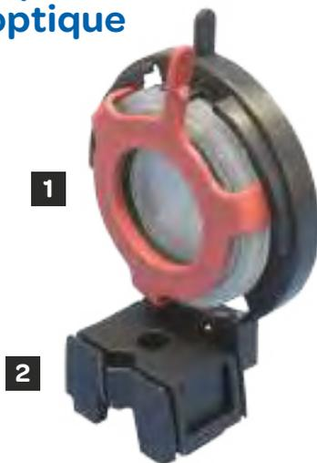
Lentille à focale variable pour l'étude de l'œil sur banc d'optique. Lentille souple remplie d'eau dont le rayon de courbure peut être modifié par pression périphérique en tournant la bague de réglage montée sur support hélicoïdal.
