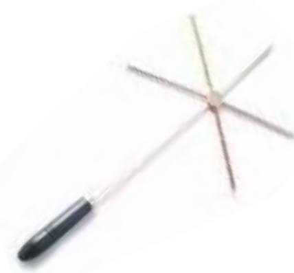
Étoile avec 5 branches métalliques : cuivre, laiton, fer, aluminium et nickel pour montrer la vitesse de propagation de la chaleur dans différents métaux.
