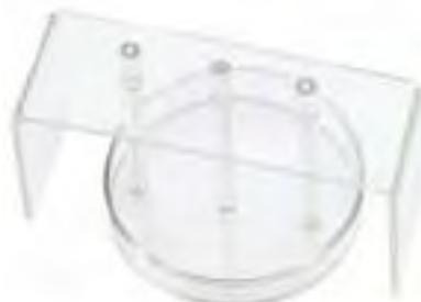
3 tubes capillaires en verre de diamètres internes de 1 à 3 mm sont fixés sur un support en plexiglas.
