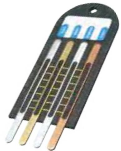
Appareil permettant de mettre en évidence les différentes conductibilités thermiques des métaux et alliages.
