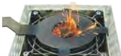
Plaque en acier épais à placer sur la grille du LAB 2 ou LAB 3 pour les expériences de combustion avec les pastilles écoflam (réf. 930 017).
