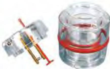
Calorimètre à double paroi dont le couvercle est équipé d'une résistance plongeante spiralée, d'un agitateur manuel et d'un passage pour thermomètre.
