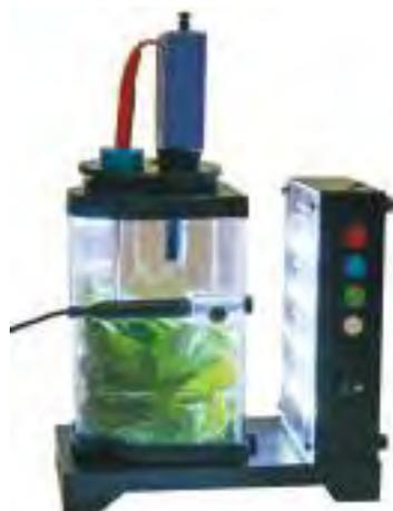
Pour l'étude de la photosynthèse et de la respiration. Composée d'une enceinte en plastique transparent équipée d'un couvercle avec 2 trous  $\varnothing$  27 mm avec bouchons pour recevoir différentes sondes : oxymètre et/ou CO<sub>2</sub> mètre et thermomètre.
