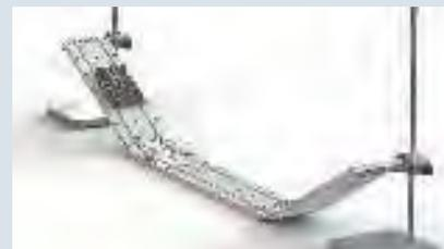
Le Chronotimer réf. 002 155 (voir page ci-contre), permet de mesurer la durée de passage d'un mobile entre 2 fourches optiques. La première fourche déclenche le chronométrage, la deuxième l'arrête.
