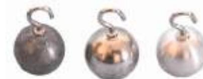
Jeu de 3 sphères de diamètre 19 mm de masses différentes avec anneau de suspension.
